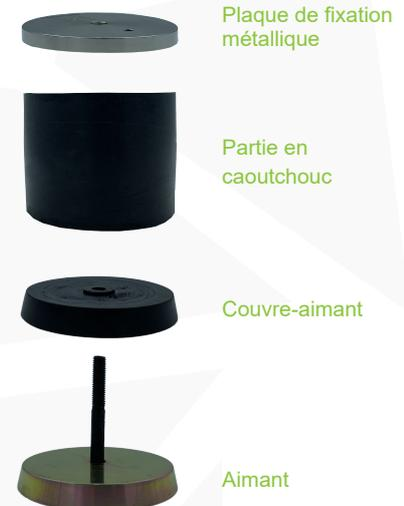
La partie en caoutchouc peut facilement être fixée à l'aimant grâce à une clé Allen. Plus la partie en caoutchouc est comprimée, plus elle gonfle et s'adapte au diamètre du tube.
